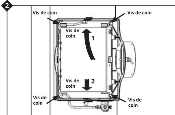
Ouvrez le couvercle et retirez l'ensemble du pare-vapeur. L'humidificateur est autoportant. Glissez le dessus en premier, puis glissez le châssis vers le bas. Mettez le châssis au niveau et vissez les vis centrales. Si le tuyau de dérivation est situé du côté opposé du châssis, pliez les fixations sur le châssis, retirez le conduit latéral d'évacuation et réinstallez le conduit d'évacuation de l'autre côté du châssis. Vissez les vis restantes aux quatre coins.
