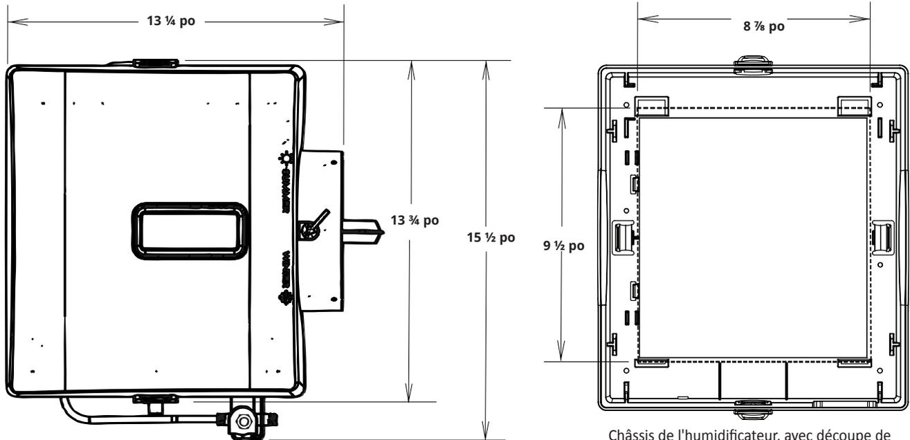
Châssis de l'humidificateur, avec découpe de la chambre de distribution illustrée par des lignes pointillées.
