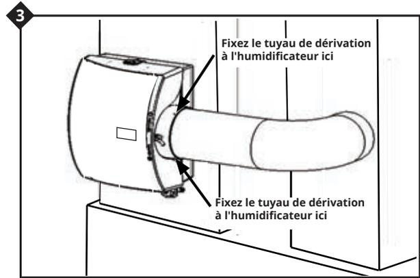
Reliez le tuyau de dérivation à la bague et au boîtier de l'humidificateur. En utilisant les trous situés au haut et au bas du panneau latéral d'évacuation, vissez deux vis autotaraudeuses par le tuyau de dérivation.
