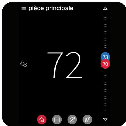
Un **écran d'accueil** simple et central affiche la température actuelle, le mode actuel et une glissière pour régler la température. Les utilisateurs peuvent également ajuster le point de consigne à l'aide des flèches. Les écrans de niveau supérieur sont accessibles via des icônes en bas de cet écran.
